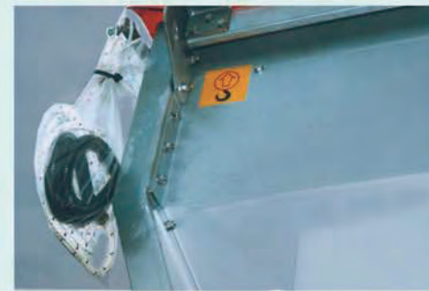
Estructura en acero inoxidable, totalmente atornillada
