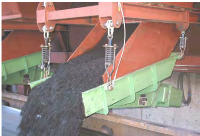
Alimentadores vibrantes para grandes caudales.
