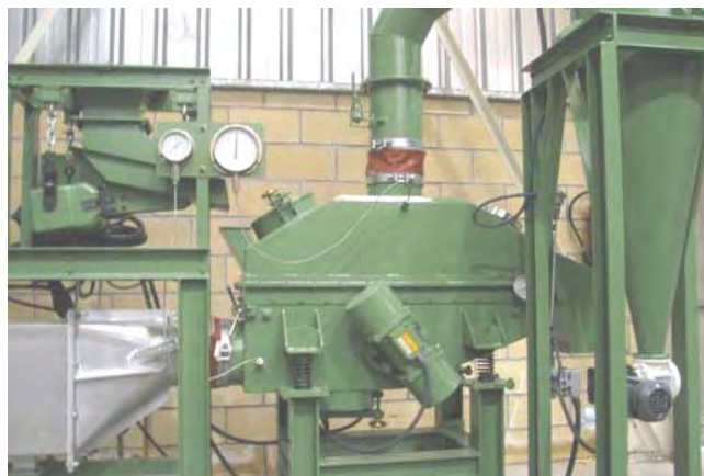
Secadores-Enfriadores de lecho fluido.
