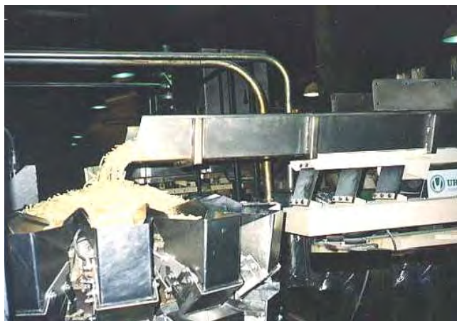
Transportadores vibrantes de caudal regulable.
