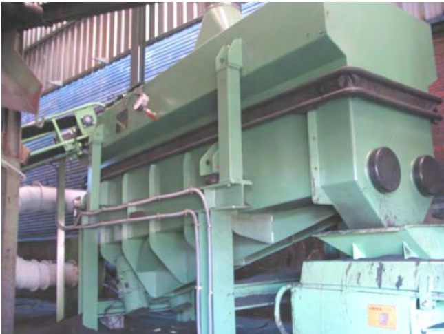
Accionado mediante 2 vibradores eléctricos externos.
