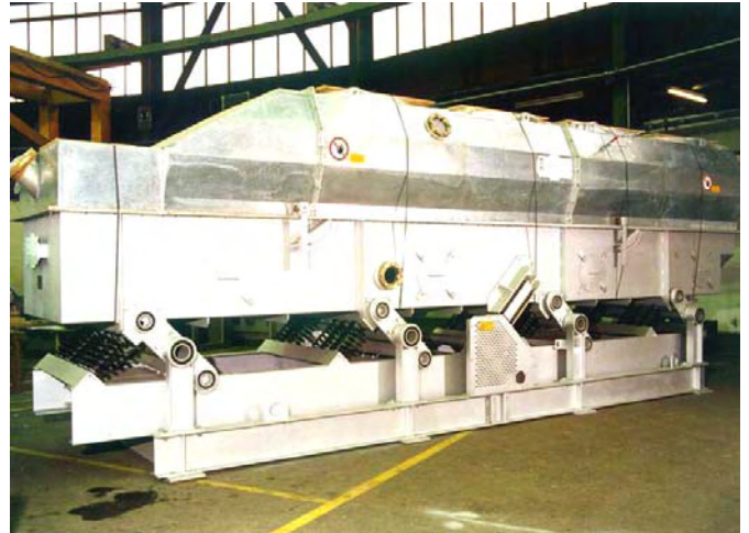
Accionado por un sistema de frecuencia natural.
