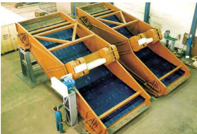
Cribas accionadas por vibrador mecánico, con movimiento unidireccional o lineal.
