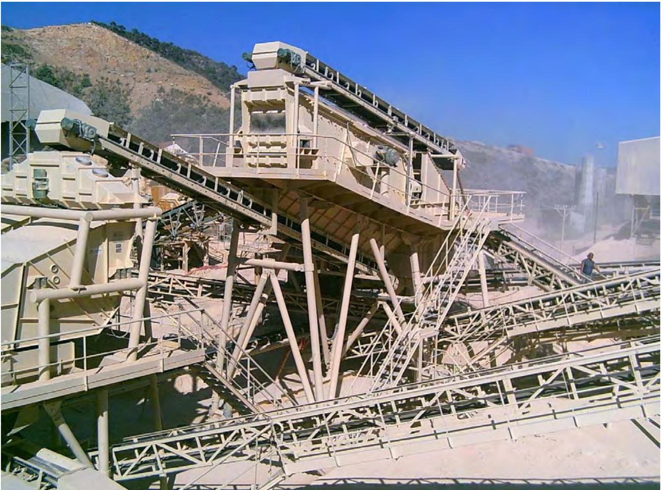
Se trata de equipos que pueden ser utilizados en la separación de productos de todo tipo cuya granulometría se sitúa entre 1 y 150 mm, alcanzando un caudal de hasta 1500 t / h.
