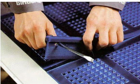
Los paneles de poliuretano pueden utilizarse en cualquier posición, son extremadamente robustos, resistentes al desgaste y además intercambiables entre sí.
