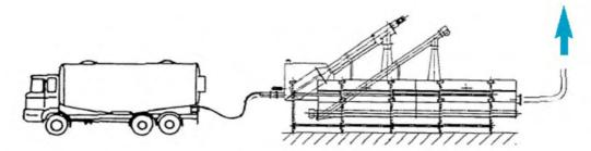
Dicho tratamiento debe eliminar los sólidos y, en su caso, la arena y las sustancias grasas existentes, evitando, de ese modo, sobrecargas y alteraciones de funcionamiento en las plantas depuradoras. Las aguas residuales se descargan desde el camión cisterna a través del racor rápido del contenedor.
