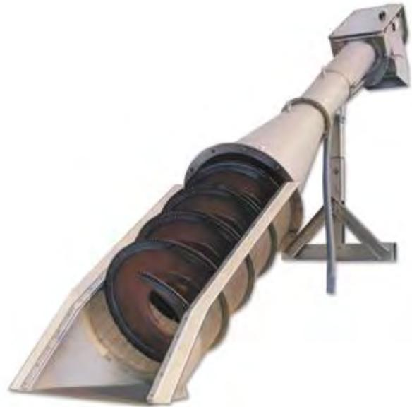
La **criba** está formada por un tamiz con luces de paso entre 0,25 y 7 mm, que retiene los sólidos en suspensión en el líquido de transporte. Dicha criba se mantiene limpia gracias al correspondiente cepillo fijado en la parte externa de la hélice.
