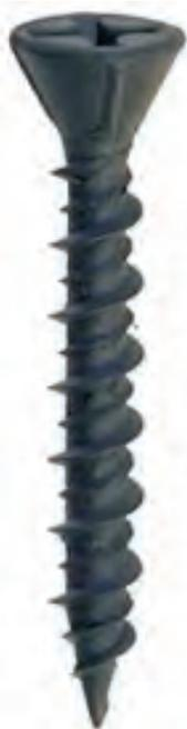
Tornillo con rosca Hi-Lo®, cabeza auto-avellanante, con mortaja Phillips®, fosfatado en color negro. Resistencia: 48 h a Test de cámara de niebla salina.
