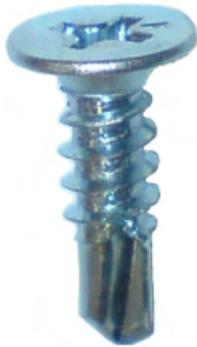
Tornillo con punta de broca autotaladrante. Cabeza plana. Mortaja Phillips. Protegido contra la corrosión mediante zincado en color plata.
