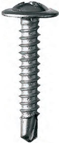
Tornillo con punta de broca autotaladrante. Cabeza ovalada con arandela estampada. Mortaja Phillips. Protegido contra la corrosión mediante zincado en color plata.
