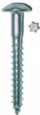
El tornillo TZX-30 está especialmente diseñado para la utilización con taco de Nylon FNG 10x 50, o roscado directamente sobre madera. Especialmente recomendado para fijación de rejas contra actos vandálicos, herrajes en sitios que requieran cierta seguridad o mobiliario urbano. Una vez atornillado se coloca el tapón de Zamak sobre la mortaja de la cabeza con un simple martillazo.
