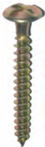
El tornillo SURTEX está especialmente diseñado para la utilización con taco de Nylon FNG 10x 50, o roscado directamente sobre madera. Especialmente recomendado para fijación de rejas contra actos vandálicos, herrajes en sitios que requieran cierta seguridad o mobiliario urbano. La mortaja en forma de Z permite el atornillado e impide por su forma el giro a la izquierda, haciendo imposible el desatornillado.
