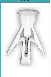
Taco deformable en el interior de la pared soporte, producido por el apriete del tornillo. Fabricado en Poliamida 6(Nylon) color neutro.
