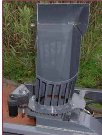
▲ Rotación eléctrica de la chimenea de expulsión Electrical rotation of snow throw
