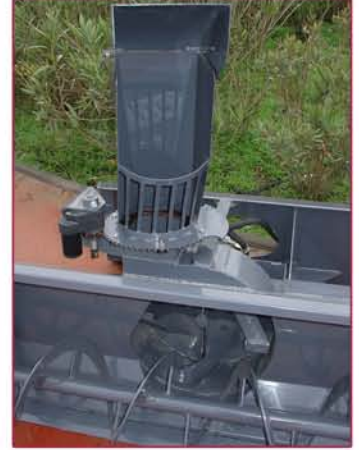
▲ Rotación eléctrica de la chimenea de expulsión Electrical rotation of snow throw
