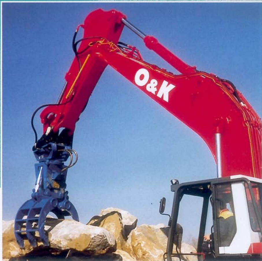
Strukturen, die nicht aus Zement bestehen und keine Stahlarmatur aufweisen. Durch die gleichzeitige Abwicklung von Abbruch und Aufladen kann erheblich Zeit eingespart werden. Die in Hinblick auf eine lange Lebensdauer entwickelten Greifer werden ausschließlich aus HARDOX 400 (Stahl mit hohem Verschleißwiderstand und einzigartigen Mechanikeigenschaften) gefertigt. Auch die effizienten Schutzverkleidungen bei Zylindern und Rotationskomponenten dienen zur Vermeidung frühzeitiger Abnutzung.
