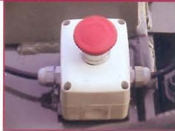
▲ Parada seguridad Stop security switch
