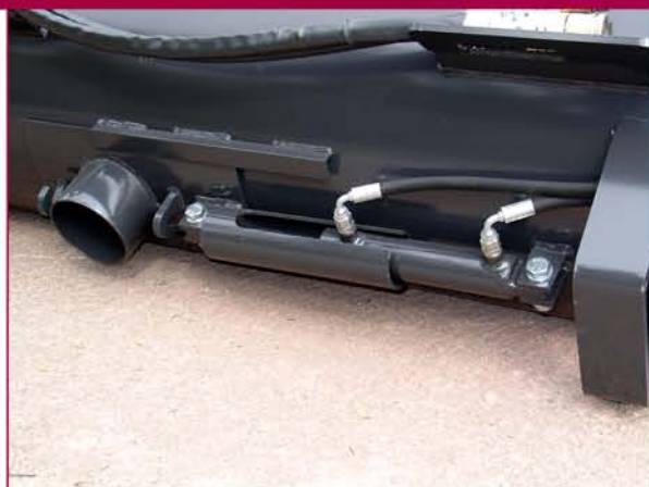
▲ Sistema de vaciado Discharging system
