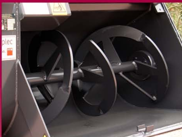
▲ Detalle eje mezclador Mixing axle detail
