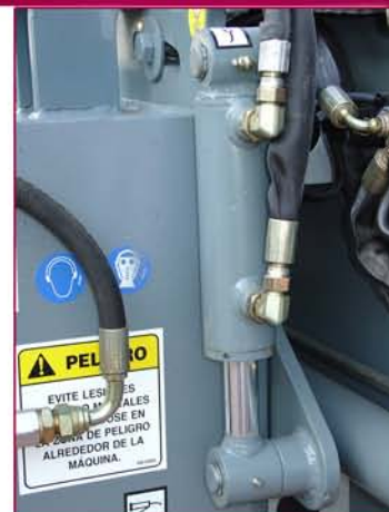
▲ Controles de profundidad e inclinación lateral mecánicos (hidráulicos opcionales) Mechanical depth control and Tilt (hydraulic optional)
