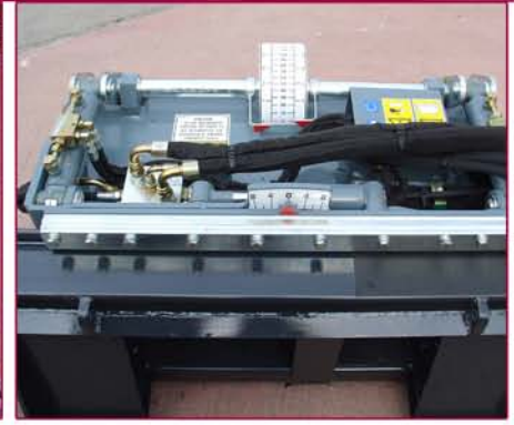
▲ Controles de profundidad e inclinación lateral mecánicos (hidráulicos opcionales) Mechanical depth control and Tilt (hydraulic optional)
