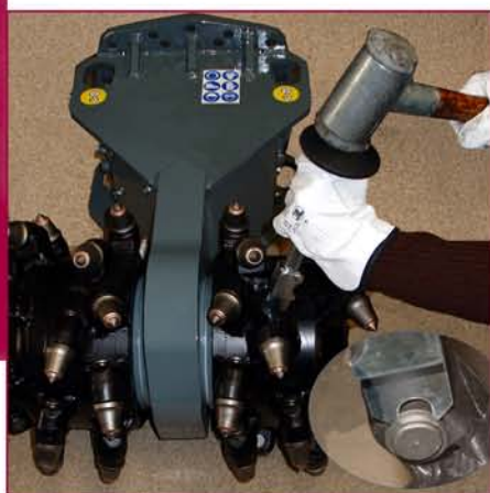
▲ Detalle de extracción de las picas Detail of the key to takeout the tools
