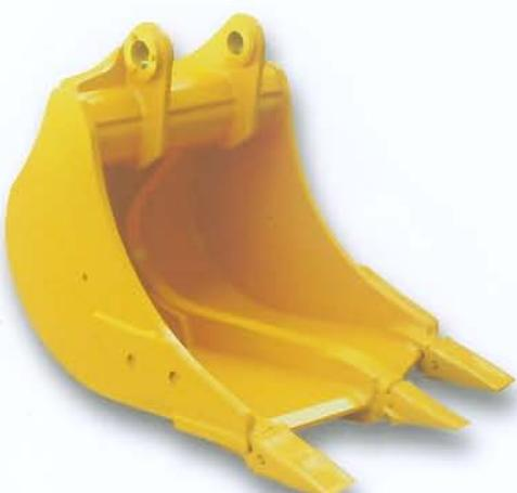
**BENNA RIPPER** - La sua particolare configurazione ne consente l'utilizzo in terreni molto compatti. La sfasatura dei denti favorisce la concentrazione di tutta la forza in un dente in modo sequenziale, aumentando così la capacità di penetrazione.
