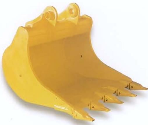
**BENNA SCOGLIERA** - Il suo tipico impiego è la movimentazione ed il successivo carico di massi e blocchi di rilevanti dimensioni. Di profilo svasato, a favorire la penetrazione, la benna scogliera è completamente costruita in HARDOX 400.
