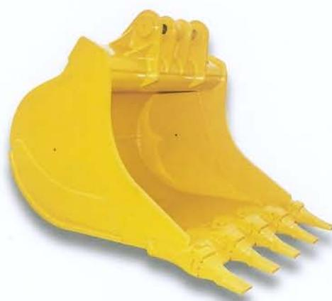
**BENNA ROCCIA** - È realizzata in HARDOX 400 nelle parti sottoposte ai maggiori carichi di tensione e più soggette all'usura; è dotata di denti adeguati e trova naturale impiego nello scavo particolarmente gravoso di terreni rocciosi.
