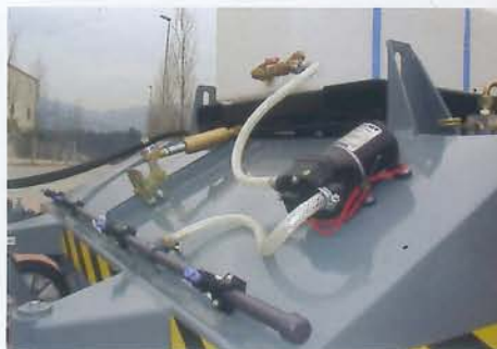
▲ Sistema de riego - opción Sprinkler system - option
