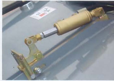
▲ Sistema de descarga hidráulico Hydraulic discharge system
