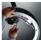
Regulación de la planaridad del cuerpo de la luminaria
