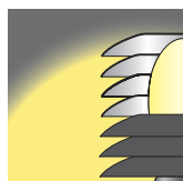
Reflector antideslumbrante para limitación del flujo hacia hemisferio superior < 3%
