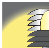
Reflector antideslumbrante para limitación del flujo hacia el hemisferio superior < 3%
