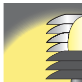
Reflector antideslumbrante para limitación del flujo hacia el hemisferio superior
