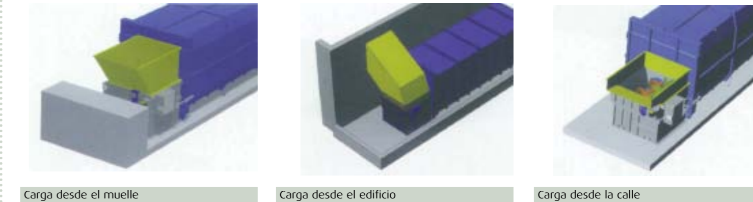
Carga desde el muelle Carga desde el edificio Carga desde la calle
