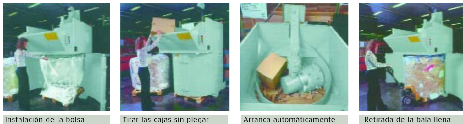
Instalación de la bolsa Tirar las cajas sin plegar Arranca automáticamente Retirada de la bala llena
