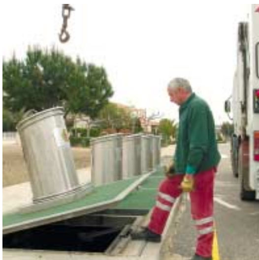
1. La tapa se levanta gracias a 2 pequeños amortiguadores de gas.
