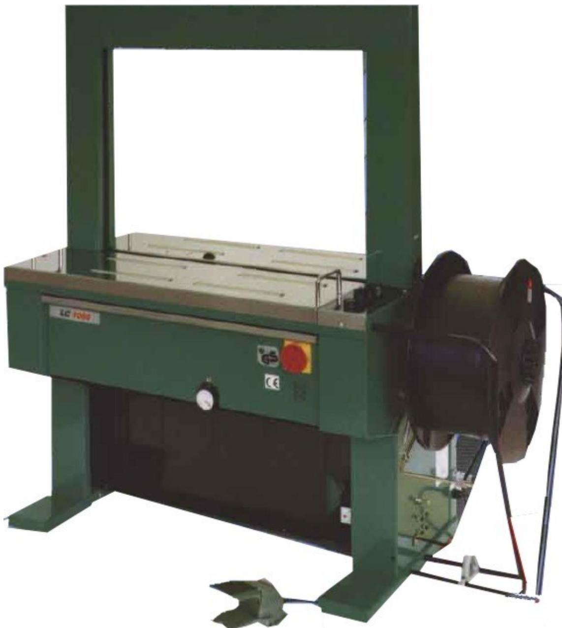
Dotada de un devanador de bobina integrado en la máquina y un sistema de enhebrado automático que facilita la sustitución de la bobina, una vez finalizada, en pocos segundos.
