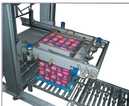
foto: Detalle carro elevacion. Compactacion capa.
