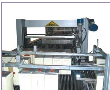
foto: Detalle paletizador para transportadores aéreos.
