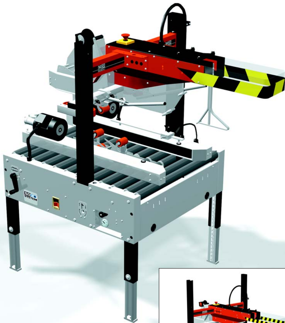
Soportes de máquina milimetrados para un ajuste exacto de la altura
