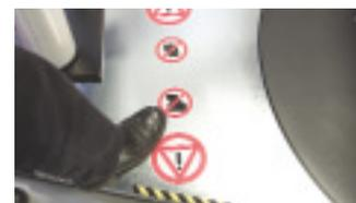
Interruptor de seguridad integrado en la plataforma del operario.
