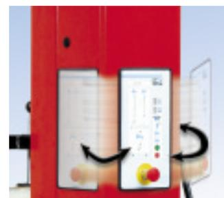
El panel de control puede colocarse a la derecha, a la izquierda, o en la parte trasera de la columna.
