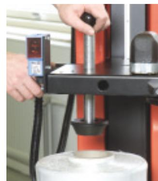
Cambio rápido de la bobina de film.
