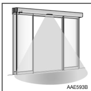
Generalmente, el sistema de seguridad tiene instalado un sensor de presencia arriba del paso de la puerta. Si el sensor de presencia detecta un obstáculo en el paso de la puerta durante el cierre, las hojas vuelven a abrirse inmediatamente. Después, reinician el movimiento interrumpido una vez que el obstáculo ha desaparecido.
