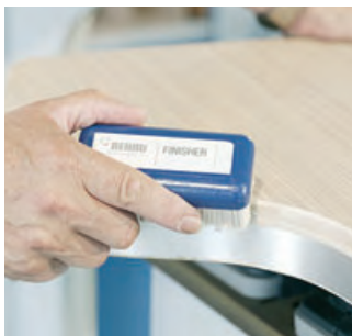
Finisher REHAU – para devolver el brillo al canto y eliminar huellas de la elaboración.
