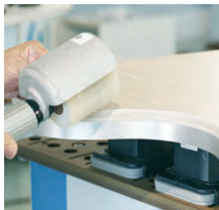
Pulidora neumática REHAU – para redondear los cantos después del corte.
