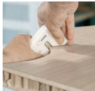
Cuchillas curvas REHAU – la herramienta para el redondeo del borde del canto.
