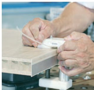
Cuchilla plana REHAU – para el corte a ras de superficie del sobrante de canto.
