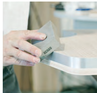
Esponja de lijado REHAU – para desbarbar los cantos cuyos bordes no puedan redondearse.
