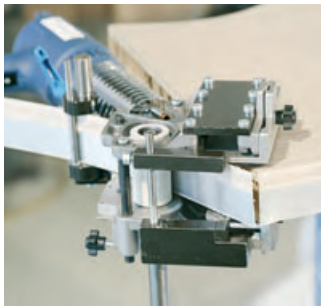
Máquina de encolado REHAU – la herramienta ideal para el pegado de los cantos preencolados.
