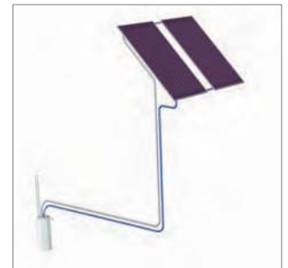
Generación de agua caliente y apoyo a la calefacción con REHAU SOLECT
