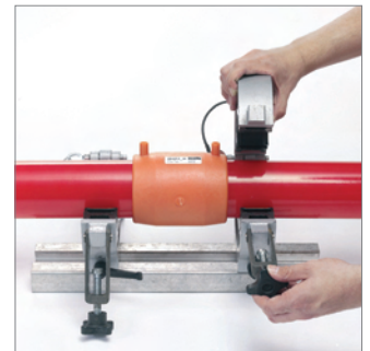
Fig. 24: Una vez vencido el tiempo de enfriamiento "cool ... min" especificado en el manguito se puede retirar el alineador de tubo universal.
