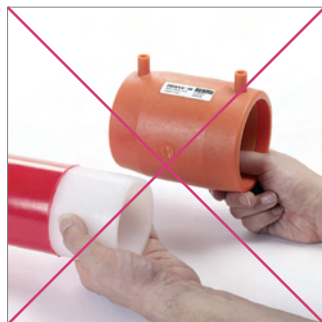
Fig. 35: No tocar las zonas a soldar. Si es inevitable que dichas zonas se ensucien, limpiarlas siempre con Tangit antes de proceder a la soldadura.
