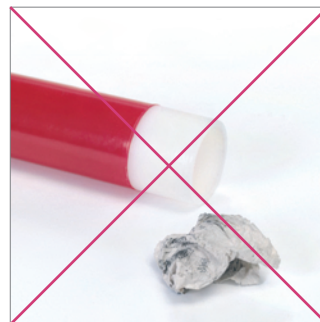
Fig. 37: No utilizar trapos usados para la limpieza. Emplear exclusivamente toallitas de celulosa nuevas resistentes al agua, no teñidas, que no dejen pelusa y sean altamente absorbentes.
