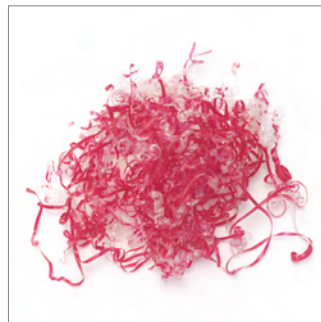
Fig. 44: Al raspar el tubo debería formarse una viruta larga y de espesor regular (0,1 a 0,2 mm). De no ser así, revisar el rascador rotativo y/o sustituir la cuchilla.
