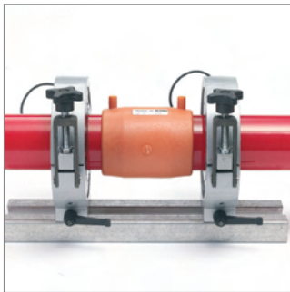
Fig. 17: Preparar el segundo extremo de tubo, introducirlo hasta el tope dentro del manguito electrosoldable y fijar el conjunto con las pinzas del alineador de tubo.
