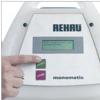
Fig. 21: Presionar nuevamente el pulsador de marcha para iniciar la operación de soldadura.
