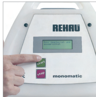
Fig. 19: Presionar el pulsador de marcha de la electrosoldadora y comprobar la instrucción de la forma que sigue: Comparar los parámetros de soldadura mostrados en el display con los valores impresos sobre el manguito electrosoldable FUSAPEX.
