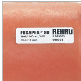
Fig. 23: No someter la unión a cargas mecánicas durante el tiempo de enfriamiento "cool ... min" especificado en el manguito.
