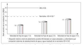
Mediciones realizadas en el Instituto Fraunhofer para Física de la Construcción, Stuttgart. Resultados de las mediciones en la planta sótano, detrás de la pared de instalación.
