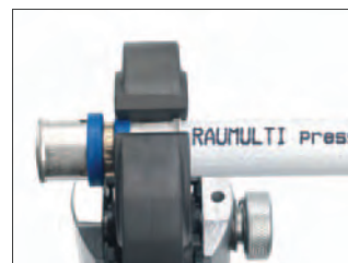
Fig. 14-4 Situar la mordaza RAUMULTI press en el casquillo de compresión
