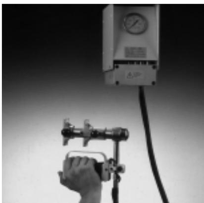
Para purgar el aire, colocar el grupo electro-hidráulico en una posición elevada y la herramienta de unión a un nivel inferior; accionar la herramienta varias veces sin generar presión.
