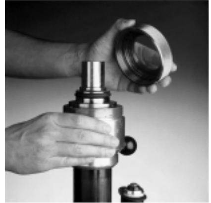
Para cambiar los cabezales ensanchadores, quitar la tuerca de sujeción, colocar los cabezales ensanchadores y enroscar la tuerca de sujeción. A partir de la dimensión de 75 mm, los cabezales ensanchadores se enroscan directamente (sin tuerca de sujeción). Enroscar igualmente del todo los cabezales ensanchadores B 75 mm.
