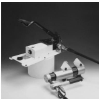
Para purgar el aire, colocar la bomba a pedal en una posición elevada y la herramienta de unión a un nivel inferior. Accionar la herramienta varias veces sin generar presión.
