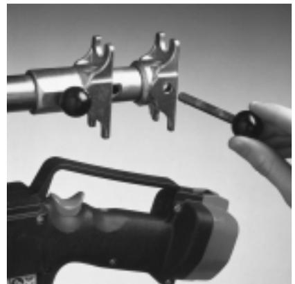
¡Fijar los cabezales de unión mediante pasadores de cabeza de bola!
