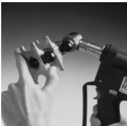
Girando el cilindro de la herramienta, los cabezales de unión y el mismo cilindro pueden situarse en la posición correcta.
