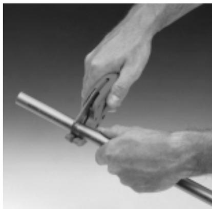
1. Cortar el tubo con las tijeras, sin rebaba y en ángulo recto, a la medida deseada. ¡Atención. Respetar la distancia de seguridad entre mano y herramienta!
