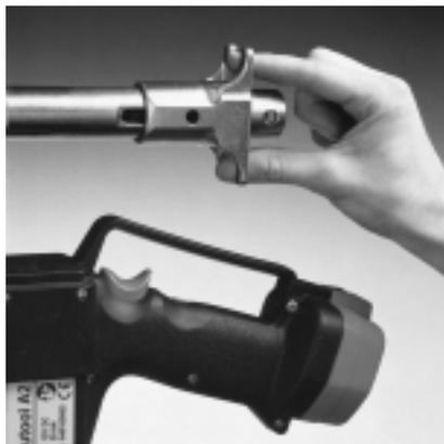
Montar siempre primero el cabezal de unión largo en el cilindro de la herramienta y después el cabezal de unión corto.
