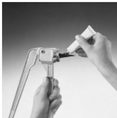
Engrasar regularmente el mandril de la tenaza abocardadora (tubo de lubricante está incluido en el suministro). No engrasar en exceso para evitar que la grasa entre en el tubo. ¡Atención. No aplicar ninguna grasa en los segmentos ensanchadores que entran en contacto con el tubo!
