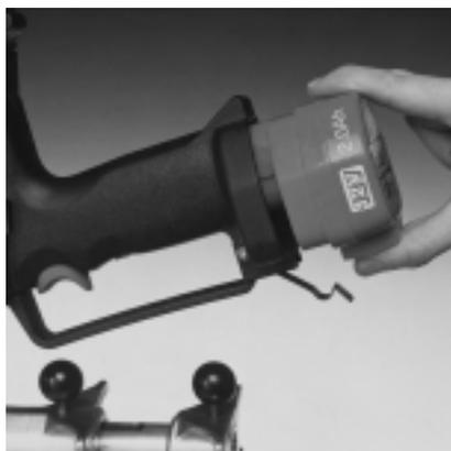
Para encajar la batería, insertarla completamente en la empuñadura y fijarla con el estribo elástico.
