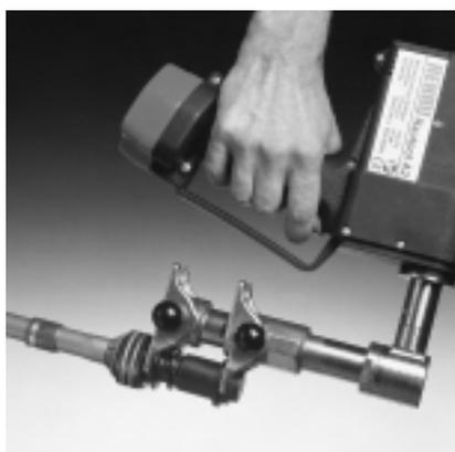
3c. Ensachar mediante abocardador hidráulico (16-32): abocardar el tubo dos veces, girándolo 30°. Prestar atención a la distancia mínima (un largo de casquillo corredizo) entre cabezal ensanchador y casquillo corredizo.
