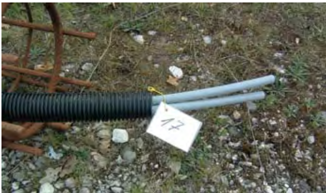
Fig. 59: Reunión de la impulsión y el retorno dentro del tubo protector
