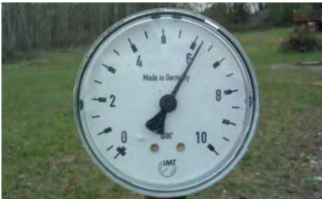
Fig. 61: Prueba de presión a 6 bar
