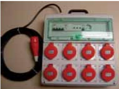
Protección de entrada: magnetotérmico 4P, C60N, 10 A, curva B y bloque Vigi de 300 mA, selectivo.
