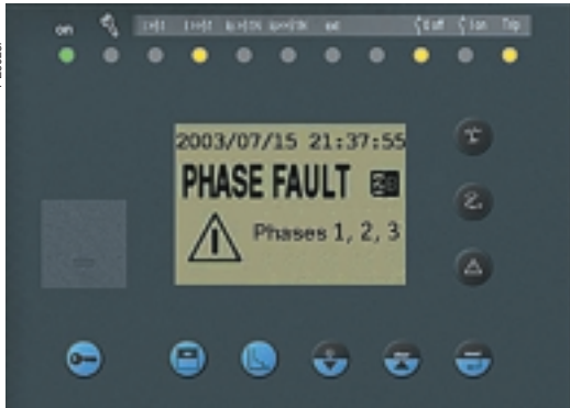
Indicaciones locales en el panel frontal de Sepam.
