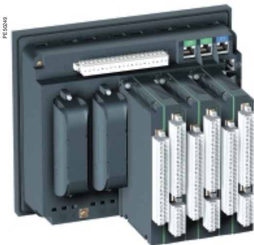
Configuración máxima de Sepam serie 80 con 3 módulos MES120: 42 entradas y 23 salidas.
