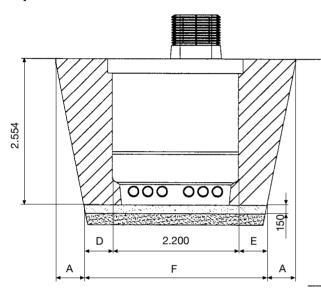
Antes de realizar la ubicación del conjunto, es muy importante reconocer el terreno y tener en cuenta las condiciones de accesibilidad para un camión con 3 ejes de 40 Tm y una grúa de capacidad 70 Tm. Previamente se requiere haber realizado una excavación en el terreno de dimensiones:
