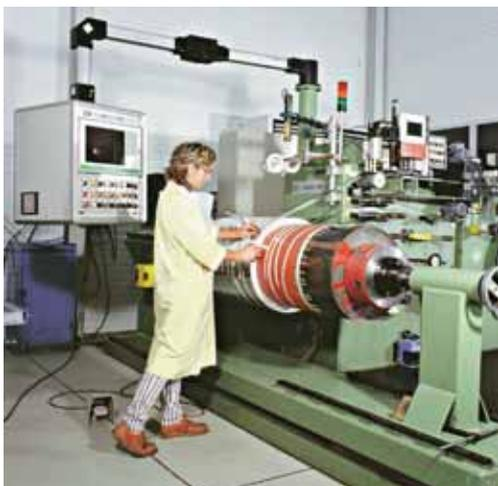
Torno para bobinas de MT en bandas.
