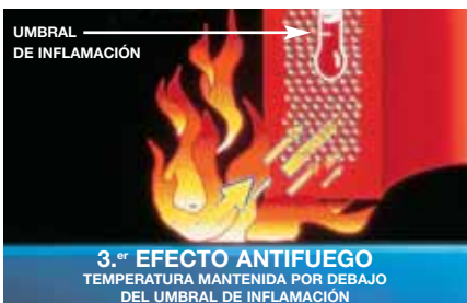
3.º efecto antifuego: mantenimiento de la temperatura por debajo del umbral de inflamación.
