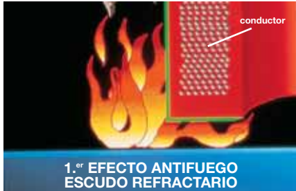
1.º efecto antifuego: escudo refractante de alúmina.
