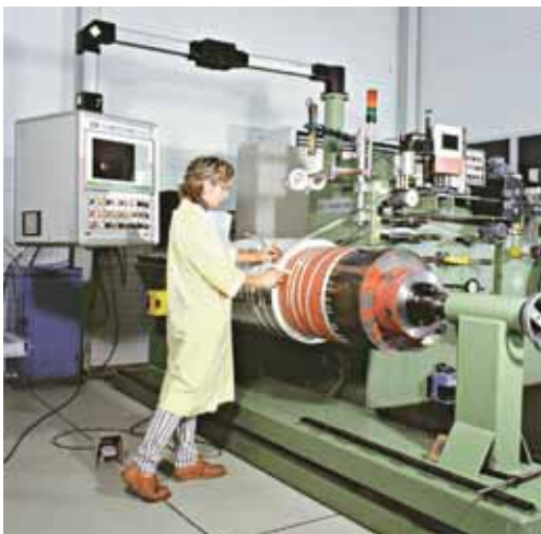
Torno para bobinas de MT en bandas.
