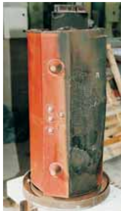
Ensayo F1 sobre una bobina completa del transformador Trihal.
