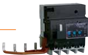
bloque Vigi NG125 para NG125 de 2, 3 y 4 polos 30 a 3000 mA clases AC, A y A "si" instantáneos, selectivos y regulables pág. 34
