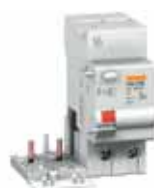
bloque Vigi C60 para C60 de 2, 3 y 4 polos 10 a 1000 mA clases AC, A, A "si" y A SiE versiones selectivas pág. 32
