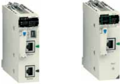
Puerto Ethernet integrado en BMX P34 2030 / 2040
