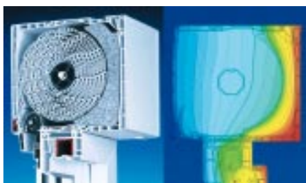
Cajón de persiana térmico-acústico Protex, con mosquetero enrollable incorporado. Valor U= 0,82 W/m 2 °K. Valor atenuación acústica Rw: 42 dB.
