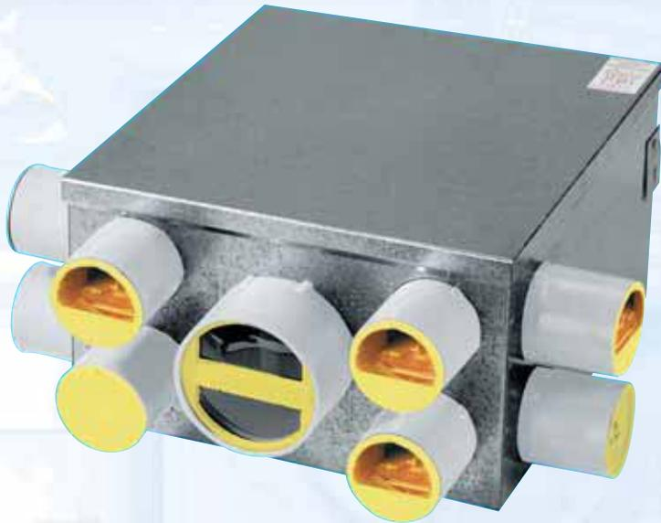
Grupo de extracción construido en acero galvanizado, que asegura la **renovación permanente del aire en viviendas unifamiliares**, mediante bocas de extracción autorregulables conectadas a través de conductos con las habitaciones húmedas: cocina, baños y aseos. Dispone de 8 bocas de extracción sanitarias y 1 para la cocina.
