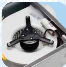
Motor de dos velocidades con condensador
