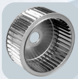
Rodete, de álabes hacia adelante equilibrado dinámicamente , según norma ISO 1940, para reducir el ruido y evitar vibraciones
