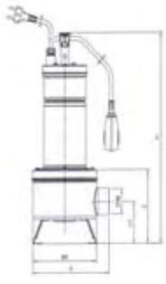
Nuestros pozos de bombeo PRPE están equipados de 1 o 2 bombas para aguas usadas o cargadas. La elección será en función de la altura y del caudal a tratar (cuidado, para instalaciones con un largo de expulsión importante, las pérdidas de cargas en la canalización deben calcularse, consulte nuestra oficina de estudios).
