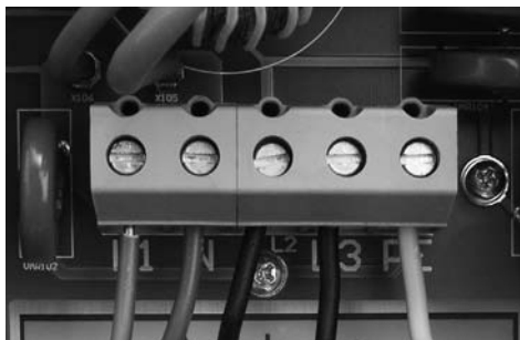
(Fig.) Borne de circuito impreso para la fijación del cable de red
