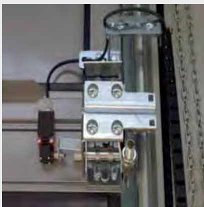
Protección contra rotura de cable
