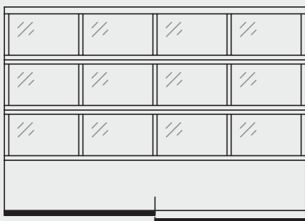
Tipo 709 – primera sección de tipo 707 (paneles tipo acero-sándwich) y 3 secciones superiores de tipo 909 (cuadrículas de perfiles extruidos de aluminio). Dividida en 4 áreas.
