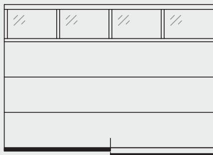
Tipo 709 – 3 secciones de tipo 707 (paneles tipo acero-sándwich) y sección superior de tipo 909 transparente (cuadrículas de perfiles extruidos de aluminio).
