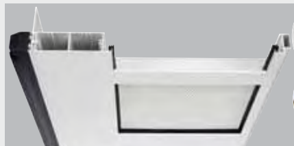
Otros rellenos para puertas seccionales del tipo 909 Relleno para aislamiento acústico tipo 909 FI, consiste de : Chapa perforada – tablero aislante – chapa lisa de aluminio.
