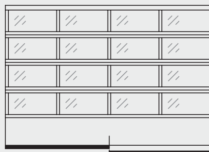
Tipo 709 – primera sección de tipo 707 (paneles tipo acero-sándwich) y 4 secciones superiores de tipo 909 transparente (cuadrículas de perfiles extruidos de aluminio) Dividida en 4 áreas.
