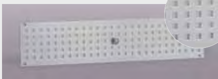
Chapa de ventilación de aluminio con pasador (se puede cerrar por dentro), agujeros rectangulares de 7 mm, dimensión 400 x 900 mm, corte transversal de la ventilación 63,7 cm 2 .
