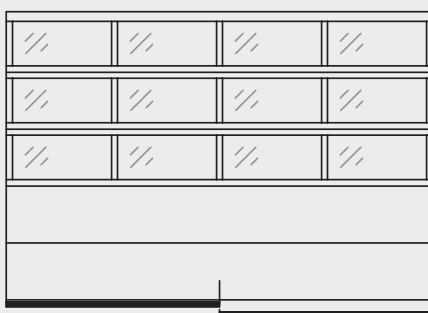
Tipo 709 – primera y segunda sección de tipo 707 (paneles tipo acero-sándwich) y 3 secciones superiores de tipo 909 (cuadrículas de perfiles extruidos de aluminio). Dividida en 4 áreas.
