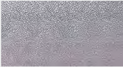
Chapa de aluminio-stucco/aluminio natural
